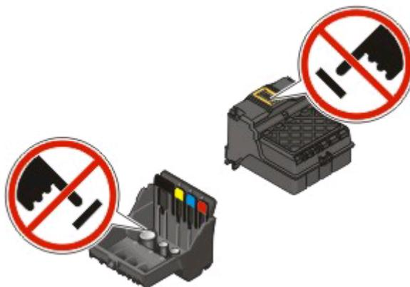
4 Вставьте печатающую головку, а затем закройте фиксатор до щелчка. *щелчка*.
